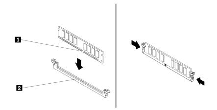
Figure 28. Installing a memory module
