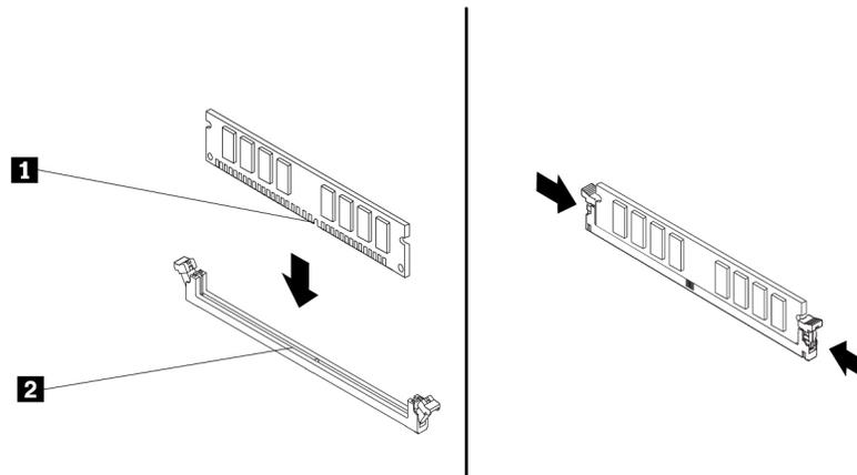
Figure 28. Installing a memory module
